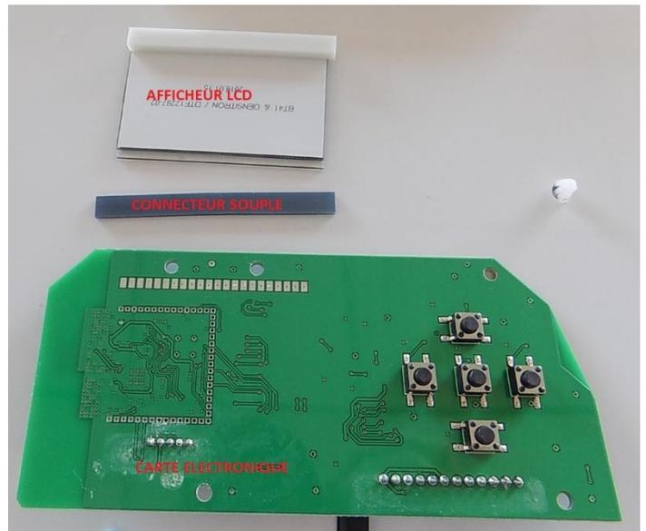
10- Nettoyez avec un chiffon doux la carte électronique et l'afficheur LCD et les 2 côtés du connecteur souple en contact avec la carte et l'afficheur. ->
